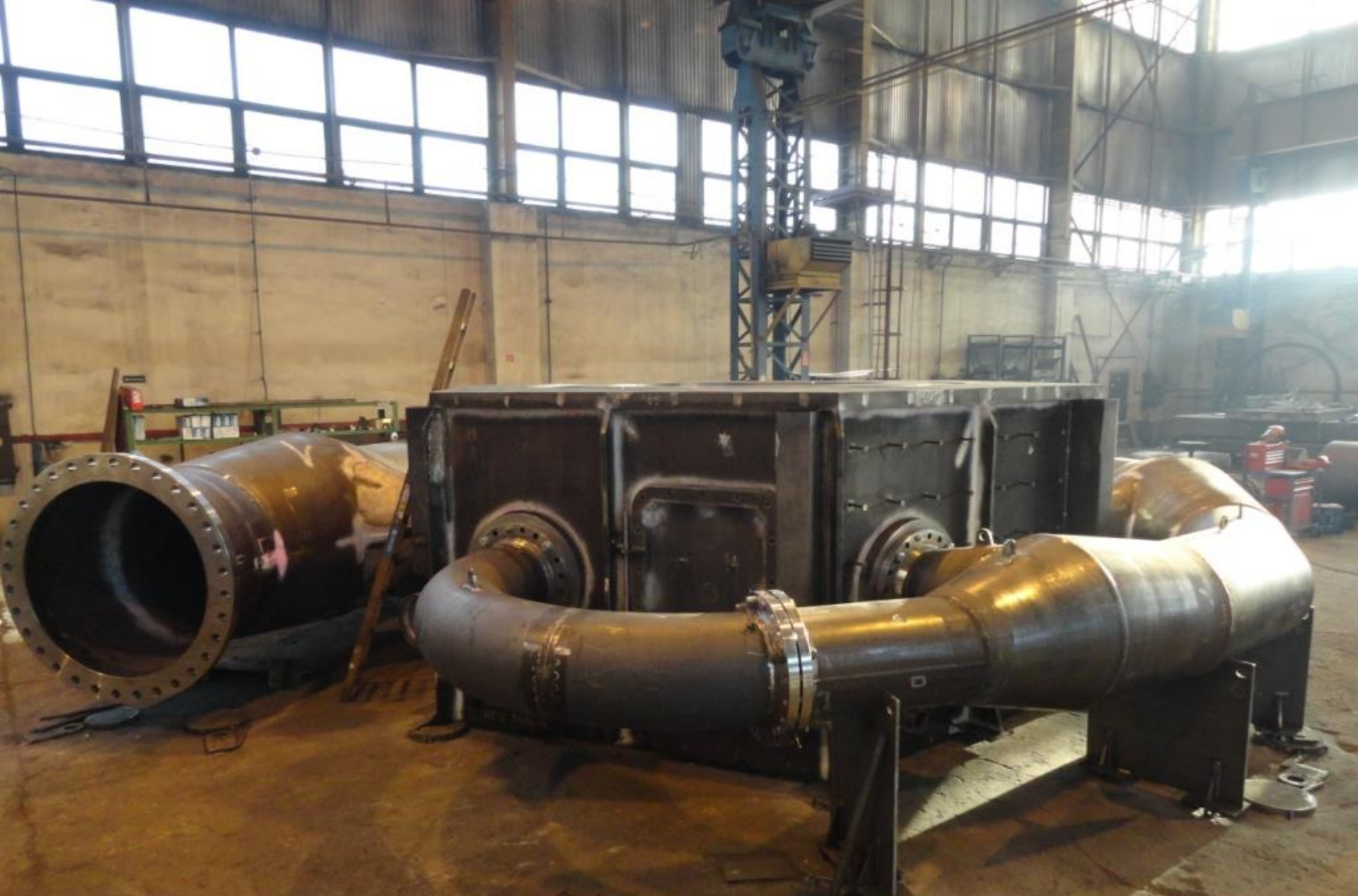
Premontaje Carcasa y Distribuidor
